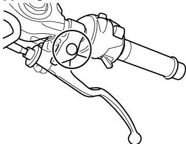
Vor Fahrtantritt die Funktion der Handbrems- und Kupplungshebel prüfen und ggf. die Drehpunkte schmieren.
