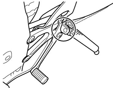
Vor Fahrtantritt die Funktion der Fußbrems- und Schalthebel prüfen und ggf. die Drehpunkte schmieren.
