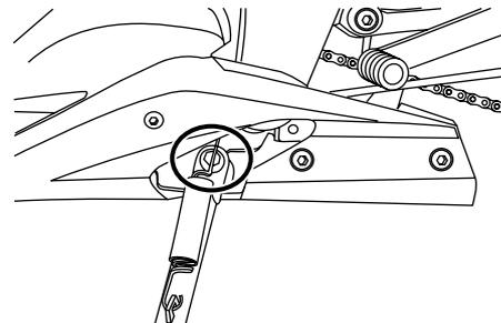
Die Funktion des Seitenständers sollte vor jeder Fahrt geprüft werden und die Drehpunkte und Metall-auf-Metall-Kontaktflächen sollten gegebenenfalls geschmiert werden.
