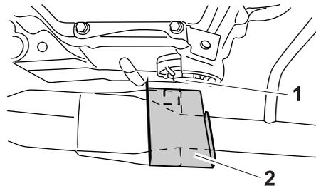
1. Motoröl-Ablassschraube (Kurbelgehäuse)
